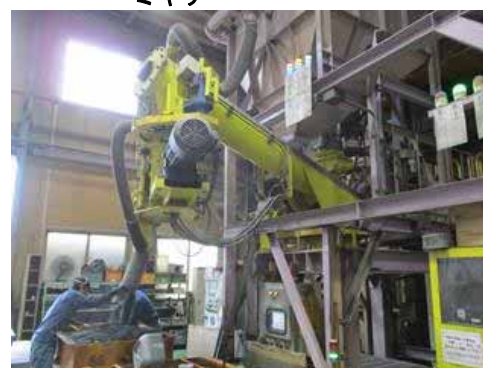
(図表9) 鋳造型用エコ・省力型ロボット ミキサー
