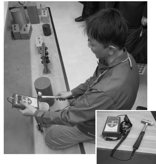
図表11 CTSを用いた検査の様子
