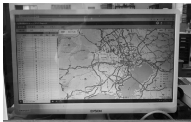
図表3 GPS機能を活用した運行状況・軌跡の管理システム
