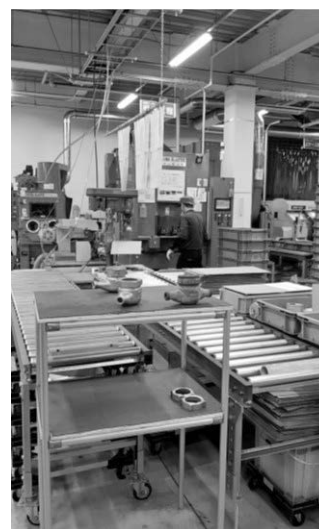
図表16 水道メーターのリサイクル工程
