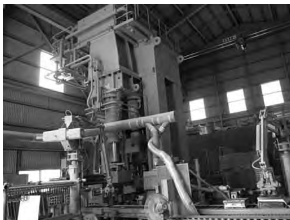
図表21 ライミックス製造用超高圧真空成型機
