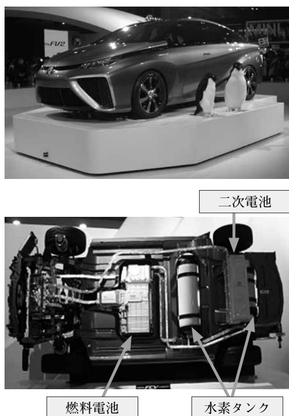
図表8 燃料電池自動車(上)と構造(下)
