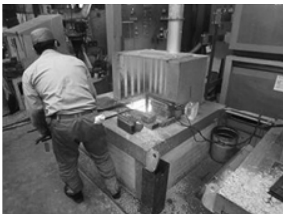
図表19 ソルトバスによる熱処理作業風景
