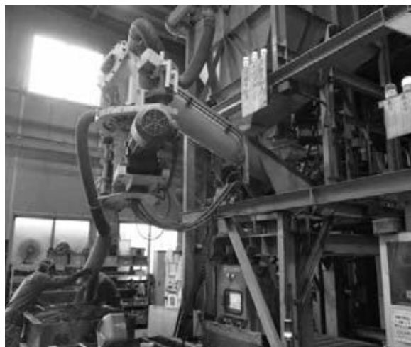
図表9 鋳造型型エコ・省力型ロボットミキサー
