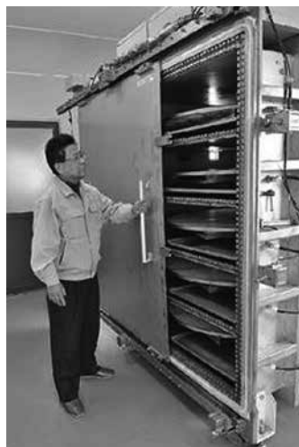
図表15 自社開発の5段型マイクロ波減圧乾燥機
