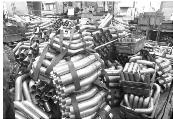
図表13 曲げ加工を施したパイプ
