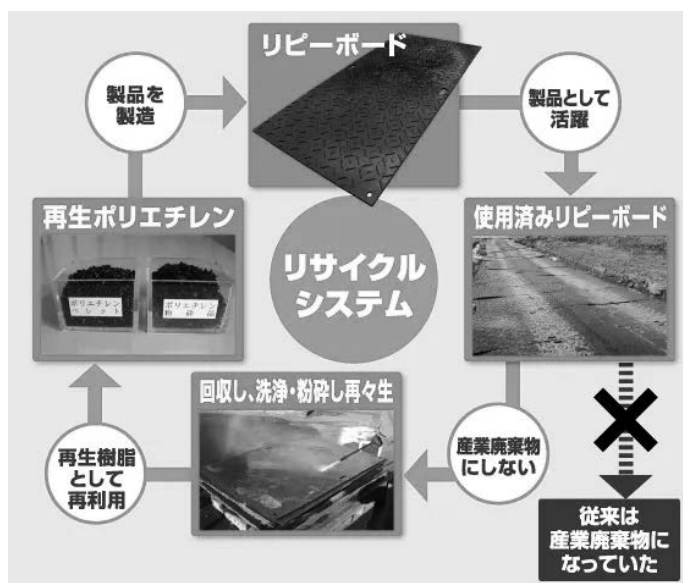
図表3 リピーボードを中核とした同社独自の「資源循環システム」
