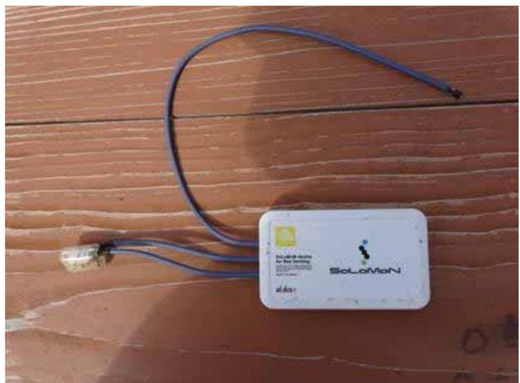
（図表8）「Bee Sensing」温度・湿度センサー
