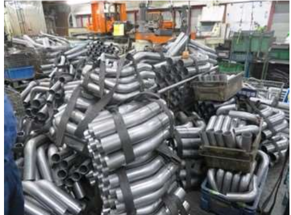
(図表 13) 曲げ加工を施したパイプ
